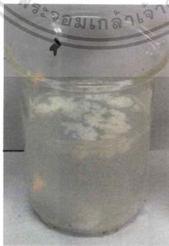
ภาพที่ 4.4 ภาพถ่ายการเกิดปรากฏการณ์ Flocculation
