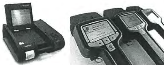
ภาพที่ 5.40 แสดงเครื่องตรวจร่องรอยสารวัตถุระเบิด (Explosive trace detection)
