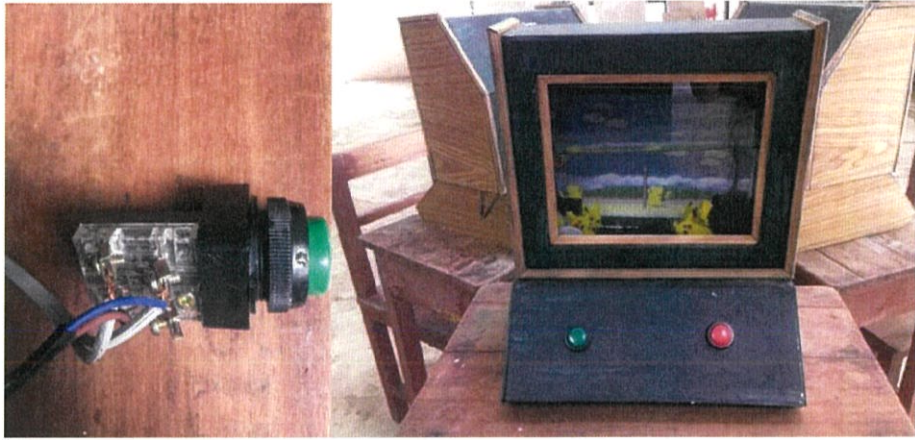
ภาพที่ 3.18 ต่อสวิตช์ไฟและประกอบหน้าจอคอม
