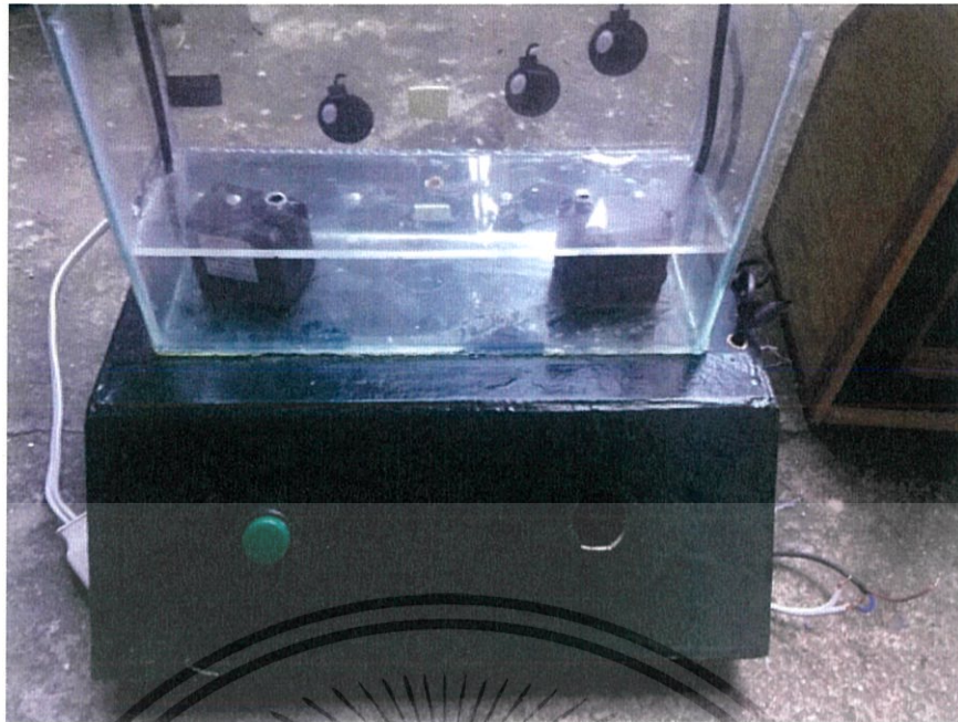
ภาพที่ 3.14 ประกอบกระจก ติดตั้งปั้มน้ำ
