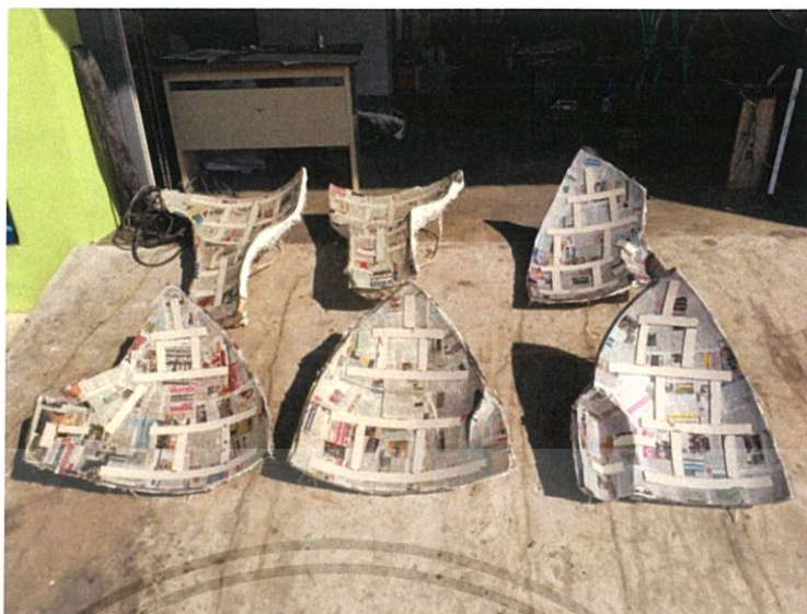
ภาพประกอบที่ 25 นำพิมพ์ปูนที่หล่อเรียบร้อยแล้วไปตากแดด
