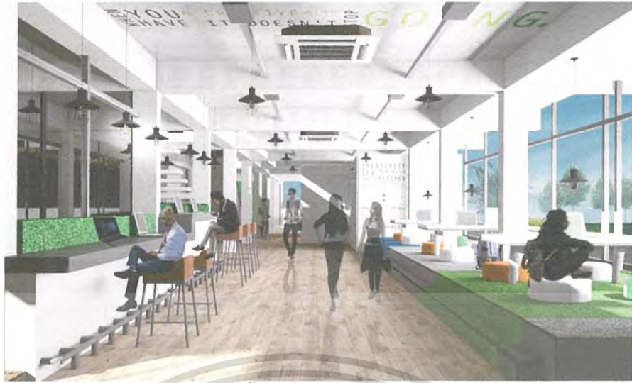
2.17 กระเบื้องลายไม้ในโครงการ แนวทางการออกแบบ โดยใช้กระเบื้องลายไม้ ปูสลับแบบลายก้ออิฐตรงพื้นที่ทำงาน
