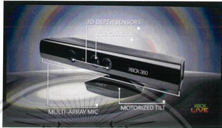
รูปที่ 2.3 แสดงส่วนประกอบสำคัญของ Hardware ใน Kinect 360
