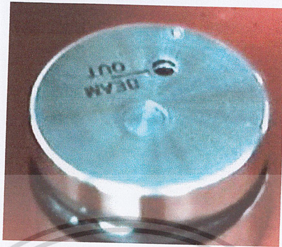
รูปที่ 2.15 ต้นกำเนิดรังสีเอ็กซ์แบบไอโซโทปรังสี[21]
