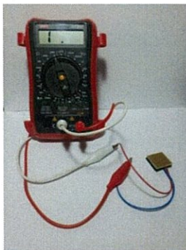
รูปที่ 3.18 เซนเซอร์แบบที่ 1 ที่ยังไม่ได้รับแรงกด
