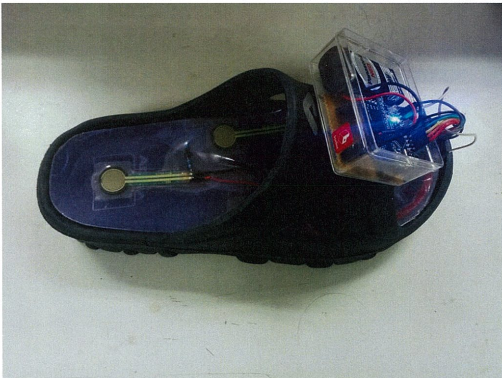
รูปที่ 4.3 เครื่องวัดแรงกดผ่านเครือข่ายไร้สายสำหรับการเดิน
