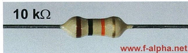
รูปที่ 2.10 ตัวต้านทานขนาด 10 K \Omega
