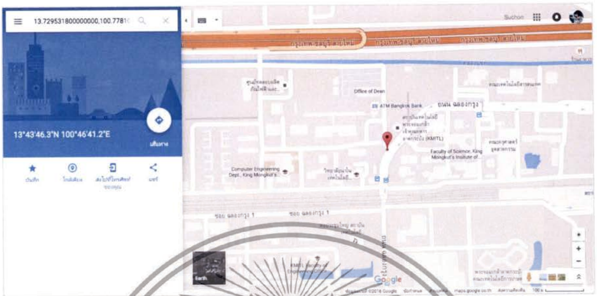
รูปที่ 4.24 แสดงตำแหน่งที่เกิดเหตุบนแผนที่ จากรูป 4.24 เมื่อผู้ใช้งานคลิกที่ปุ่ม View จากหน้ารายการอันดับในระบบจะทำการเปิดแผนที่ และส่งค่าตำแหน่ง ละติจูด ลองจิจูด ไปยัง Google Map เพื่อ Mark จุดที่เกิดเหตุด้วย
