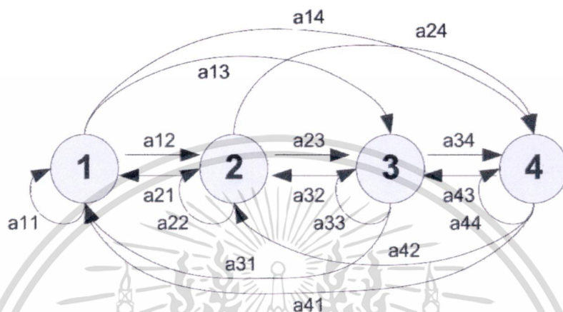
ภาพที่ 2.4 แบบจำลองฟูลลีคอนเนคโทโปโลยีโดยมี 4 สถานะ
