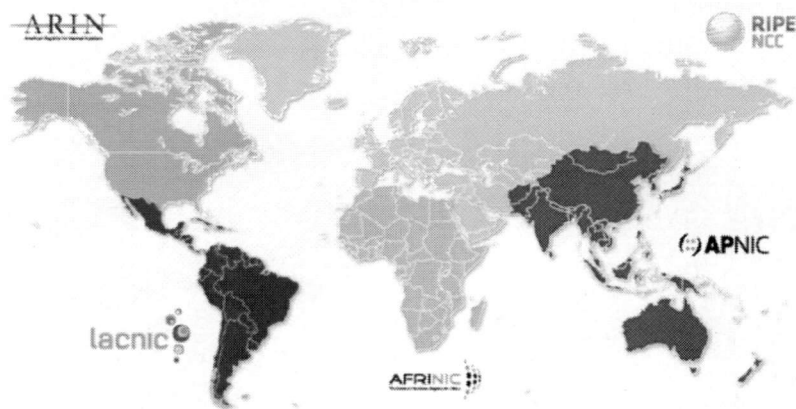
รูปที่ 2.2 รูปแสดงการแบ่งโซนผู้ดูแลการกำหนดหมายเลขไอพีในอินเทอร์เน็ต
