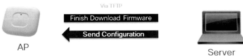
รูปที่ 3.6 เซิร์ฟเวอร์ส่งชุดคำสั่งการกำหนดค่าให้ AP
