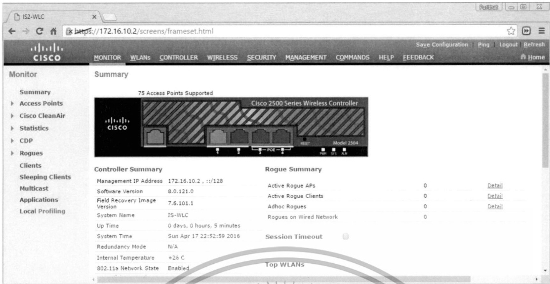
รูปที่ 4.4 ทดสอบใช้งาน WLC ผ่าน Web Browser
