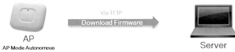
รูปที่ 3.10 AP ดาวน์โหลดเฟิร์มแวร์ Lightweight จากเซิร์ฟเวอร์
