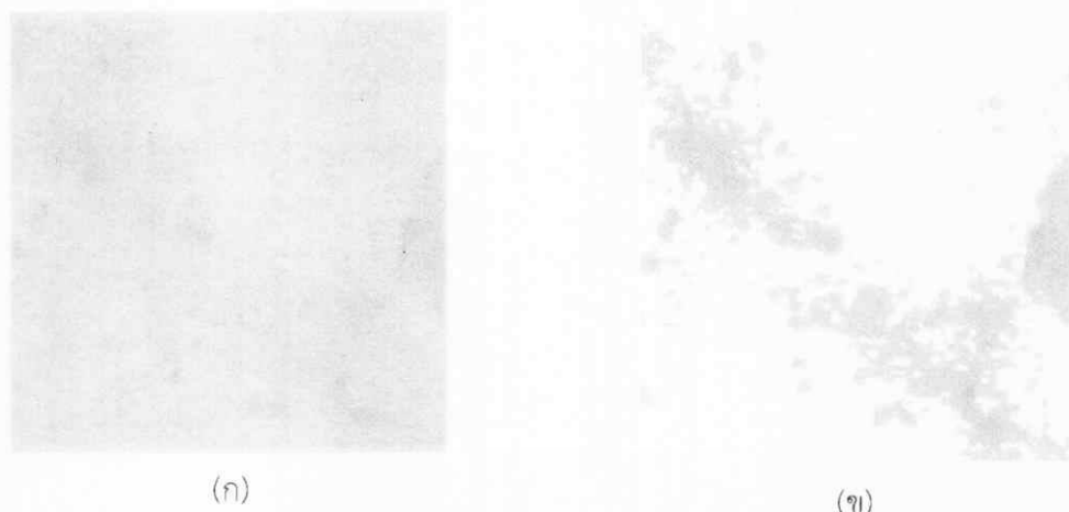
รูปที่ 4.24 ภาพองค์ประกอบ Hue (ก) ก่อนและ (ข) หลังการเทรสโฮลด์ด้วยวิธีการของ Otsu
