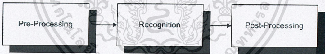
รูปที่ 2.4 แผนภาพแสดงโครงสร้างหลักของ OCR
