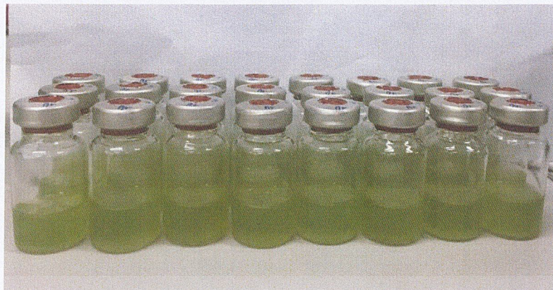
รูปที่ 4.6 ขวดแก้วเก็บก๊าซ (gas-tight vial) บ่มเป็นเวลา 4 ชั่วโมง เตรียมวิเคราะห์การผลิตไฮโดรเจนที่ผลิตได้โดยเครื่อง GC-TCD
