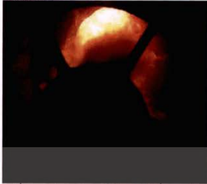
รูปที่ 6 การเกิดปรากฏการณ์ไฟลอยไปติดที่เตาเผาส่วนหลัง
