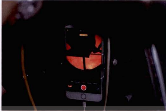
รูปที่ 5.28 ตำแหน่งการตั้งอุปกรณ์เพื่อบันทึกวิดีโอภาพภายในหัวเผา
