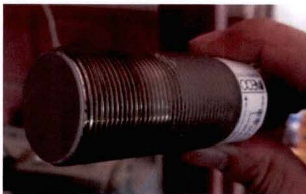
รูปที่ 5.10 เครื่องมือวัดระดับชนิดเก็บประจุ (Capacitive Sensors)
