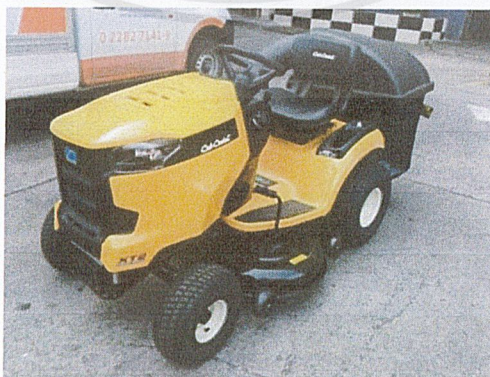
ภาพที่ 2.20 เครื่องตัดหญ้าแบบหมุนเหวี่ยงแนวราบ ที่มา : MTD (2016)
