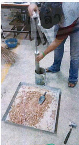
รูปที่ 3.16 การบดอัดดิน
