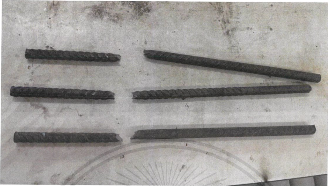
รูป จ.3 ผลการดึงเหล็กเปล้า เส้นผ่าศูนย์กลาง 16 มิลลิเมตร ตัวอย่างที่ 1 ถึง 3
