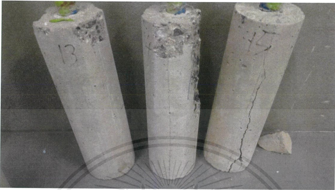
รูป ช 9.ผลการทดสอบการดึงทิศทางเดียว ตัวอย่างที่ 13 ถึง 15
