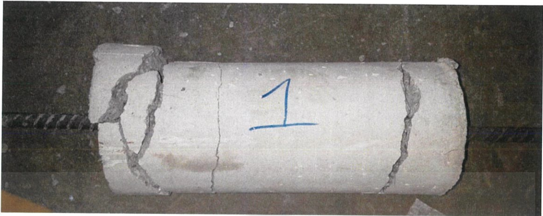
รูป 4.3 ผลการดึงสองทิศทางเหล็กเส้นสนิมผ่าศูนย์กลาง 16 มิลลิเมตร ตัวอย่างที่ 1
