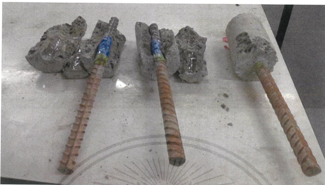
รูป ช 13.ผลการทดสอบการดึงทิศทางเดียว ตัวอย่างที่ 25 ถึง 27
