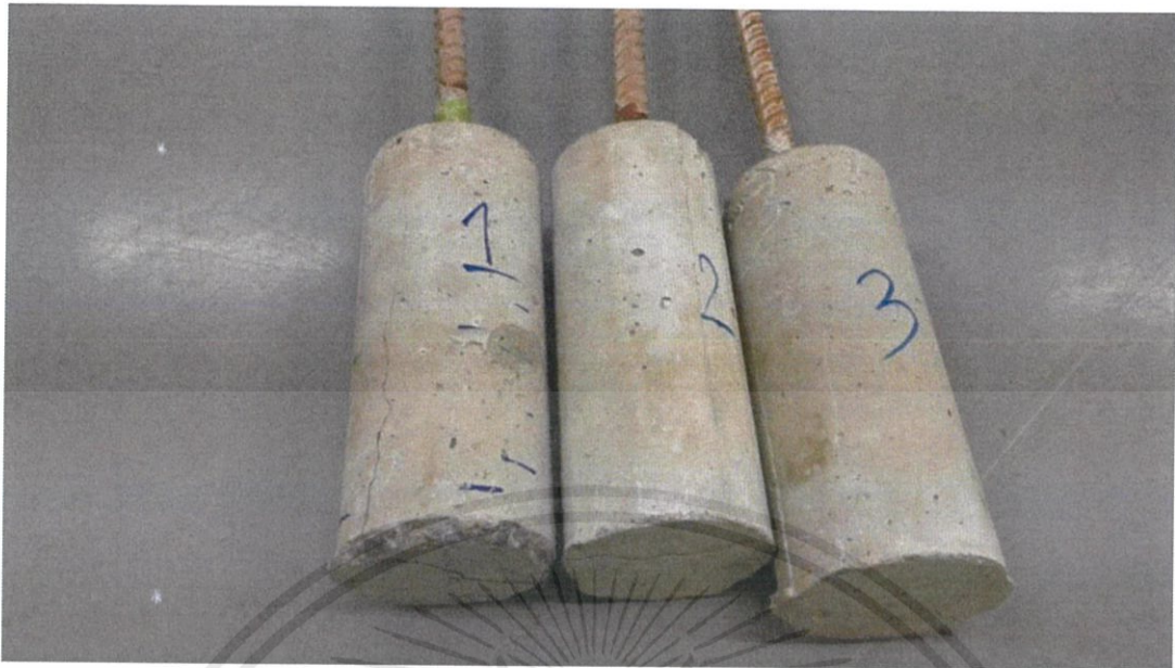
รูป ช 5.ผลการทดสอบการดึงทิศทางเดียว ตัวอย่างที่ 25 ถึง 27
