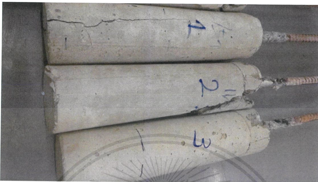
รูป ข 1. ผลการทดสอบการดึงทิศทางเดียว ตัวอย่างที่ 15 ถึง 13
