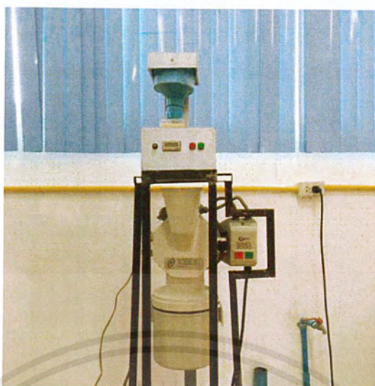
รูปที่ 3.6 การตั้งเครื่องป้อนเมล็ดข้าวและเครื่องลดขนาดแบบค้อนเหวี่ยง
