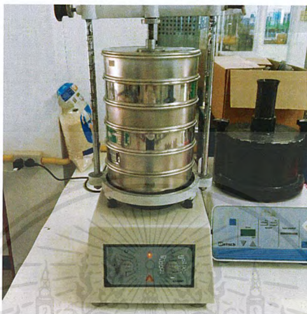
รูปที่ 3.9 การวางชุดตะแกรงทดสอบบนเครื่องsieve shaker
