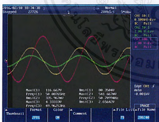
รูปที่ 4.12 แรงเคลื่อนเหนี่ยวนำ(ch2) บน search coil ที่พัน 2 รอบ แรงดัน 1 เฟสป้อนเข้า 80V ที่มุม 0° 60° 120° 180° 240° 300° ตามลำดับ (วัดจาก Magnetic axis ของขดลวดเฟส a ที่สเตเตอร์)
