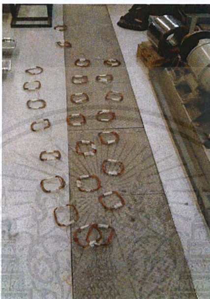
รูปที่ 4.16 การตรวจสอบการพันของขดลวดอาร์มาเจอร์สามเฟสของโรเตอร์และนับจำนวนรอบของขดลวดทุกขดลวด
