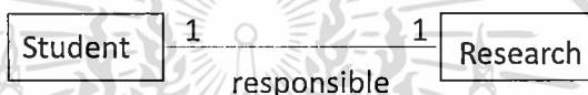
รูปที่ 2.17 ตัวอย่างแสดงการเชื่อมโยงแบบหนึ่งต่อหนึ่ง (ที่มา: Coronel, C. et al. 2011)
