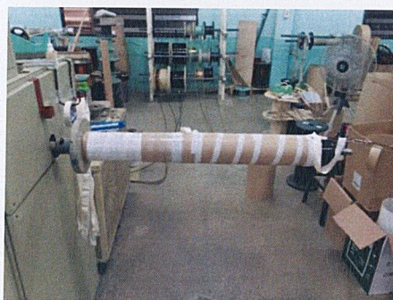
รูปที่ 3.15 mandrel ของขดลวดแรงต่ำ
