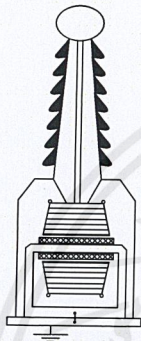
รูปที่ 1 หม้อแปลงแบบจุ่มน้ำมันตัวถังโลหะ
