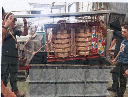
รูปที่ 3.28 นำไส้ใส่ตัวถังโลหะ
