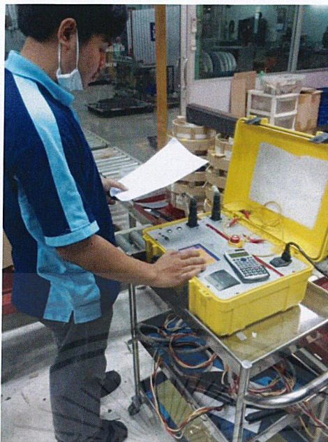
รูปที่ 4.3 วงจรการทดสอบหาค่าอัตราส่วนแรงดันโดยใช้ Turns ratio meter
