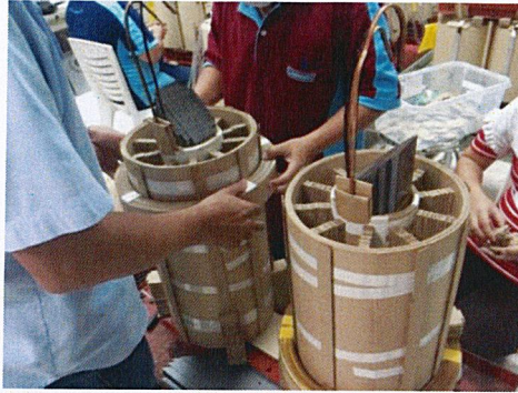
รูปที่ 3.22 สวมขดลวดแรงสูงครอบขดลวดแรงต่ำ
