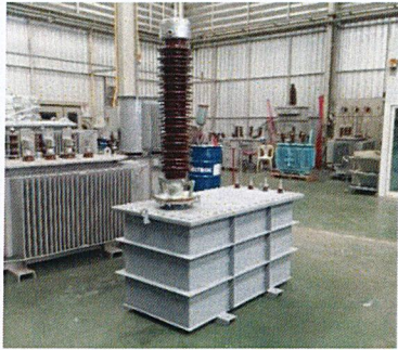
รูปที่ 8 หม้อแปลงที่ประกอบเสร็จเรียบร้อยแล้ว
