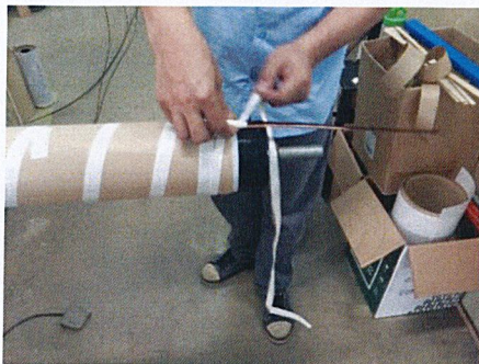
รูปที่ 3.16 พันผ้าดิบรอบขดลวดแรงต่ำ
