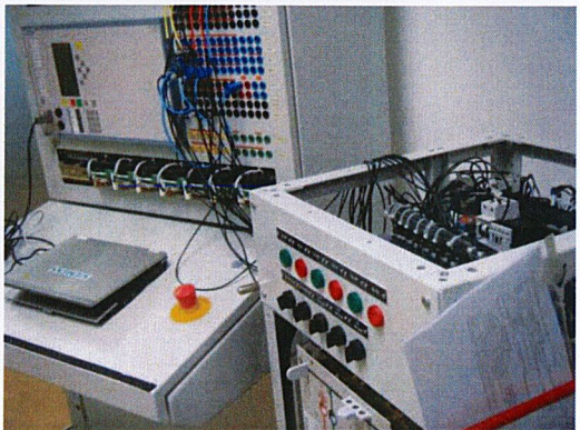
รูปที่ ๓.๔ การติดตั้งอุปกรณ์และเชื่อมต่อสายไฟภายในชุดสถานีการควบคุมสวิตช์ตามสถานะ
