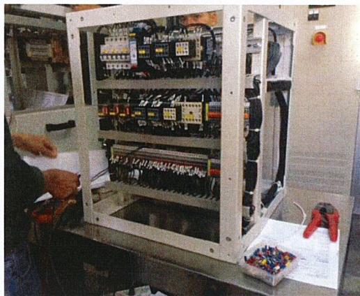
รูปที่ ญ.1 การต่อวงจรของชุดสถานีการควบคุมสวิตช์สามสถานะโดย SIPROTEC ก่อนการวิจัย
