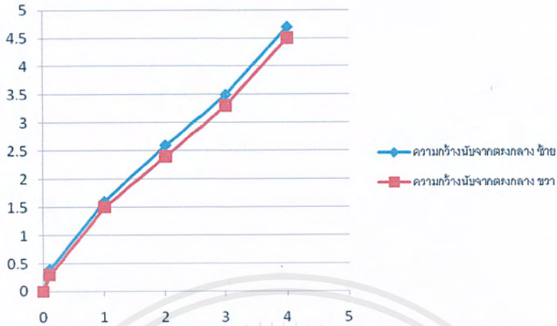
รูปที่ 4.12 กราฟแสดงความสัมพันธ์ระหว่างระยะห่างจากเซนเซอร์แบบสี่เหลี่ยม และความกว้างนับจากตรงกลางของเซนเซอร์
