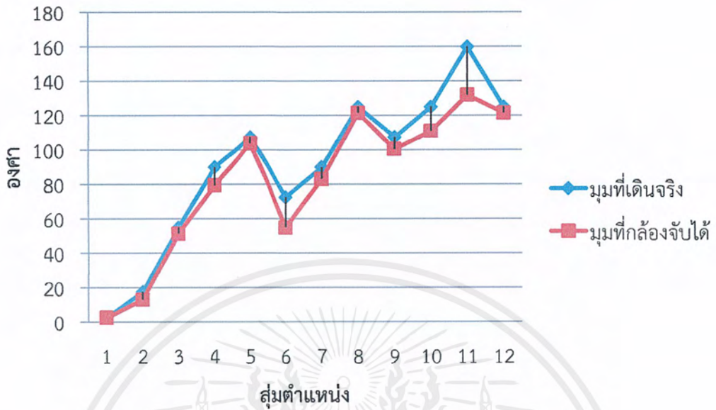
รูปที่ 4.20 กราฟแสดงองศาการหมุน Servo Motor เมื่อเทียบกับองศาที่ใช้ในการเดินกลับไปมารีศมี 1 เมตร
