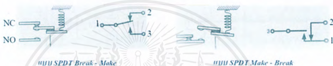
รูปที่ 2.13 หน้าสัมผัสแบบ SPDT แบบ Break-Make และ Make-Break [10]
