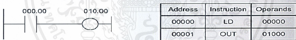
รูปที่ 2.35 รูปแบบชุดคำสั่งจาก Ladder Diagram
