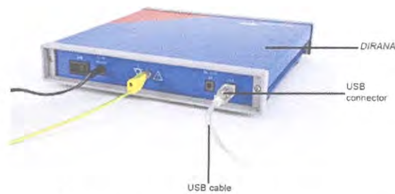
รูปที่ ง.5 การต่อสายด้านหลังเครื่อง DIRANA
