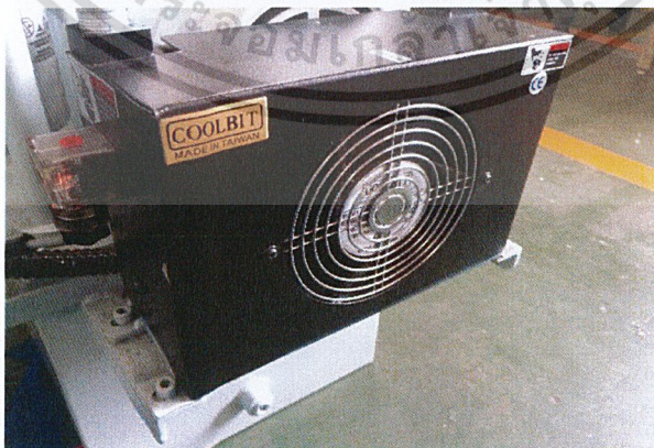
รูปที่ 4.2 พัดลมระบายความร้อนชุดไฮดรอลิกส์ ขณะทำงาน
