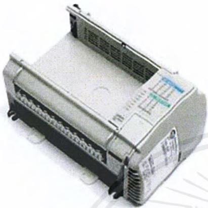
รูปที่ 2.3 Base unit ของ MicroLogix
