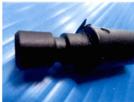
รูปที่ 4.4 การเสียหายของชิ้นงาน Casing cap
