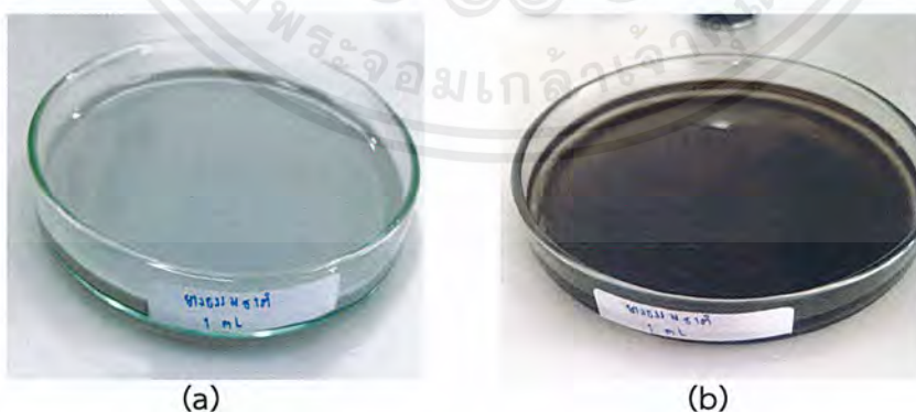
รูปที่ 3.2 แสดงการเปลี่ยนแปลงของแผ่นยางผสมยางธรรมชาติกับรีดิวซ์กราฟีนออกไซด์ที่เตรียมได้ (a) ก่อนอบ (b) หลังอบ
