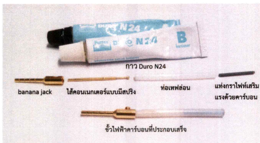
รูปที่ 4.6 ส่วนประกอบของขั้วไฟฟ้าและขั้วไฟฟ้าที่ประกอบเสร็จ
