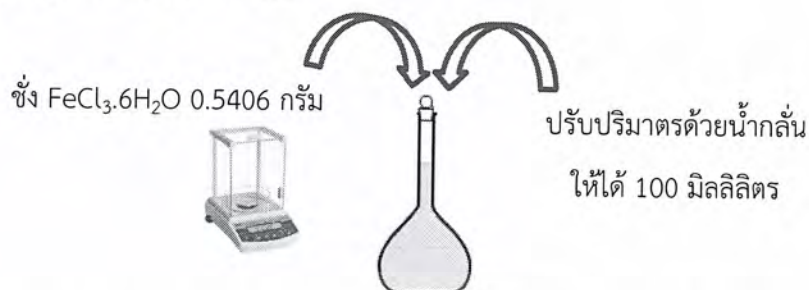
รูปที่ 16 (ข) การเตรียมสารละลาย \text{FeCl}_3 \cdot 6\text{H}_2\text{O} ความเข้มข้น 20 มิลลิโมลาร์
