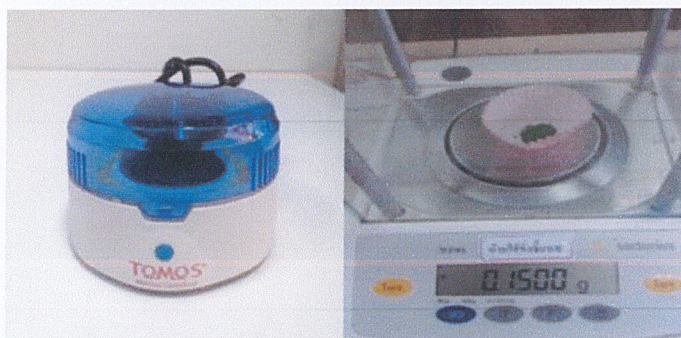
รูปที่ 3.5 เครื่องหมุนเหวี่ยงขนาดเล็ก (Minicentrifuge) (รูปซ้าย) และเครื่องชั่ง 4 ตำแหน่ง (รูปขวา)
