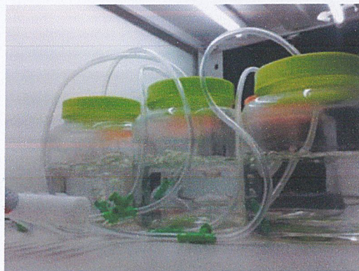
รูปที่ ข-1 การวัดระดับน้ำจากการให้อัตราการไหลของอากาศที่แตกต่างกัน
