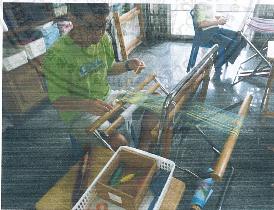
รูปที่ 3.9 การทดลองทอจากเส้นด้ายที่ช่างทอมาในหน้าผ้าขนาด 15 เซนติเมตร
