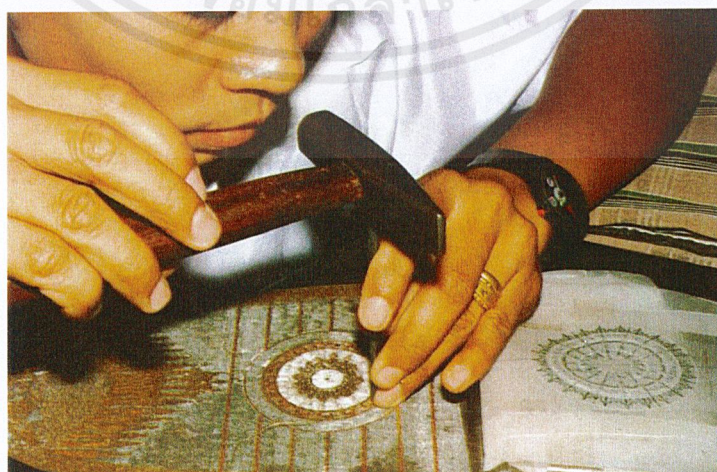
ภาพที่ 2.5 การฝังเส้นทองลงบนผิวเหล็กในการทำคร่ำทอง งานช่างโบราณในราชสำนัก
