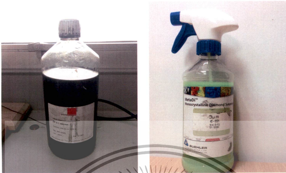
รูปที่ 3.5 น้ำยาขัดเพชร (Monocrystalline Diamond Suspension) ความละเอียด 3 \mu\text{m} และ 0.1 \mu\text{m}
