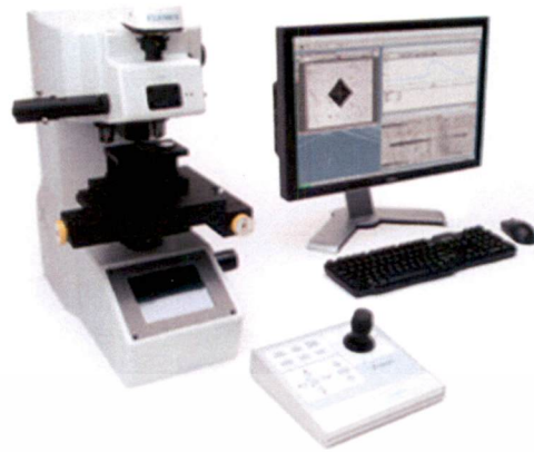
รูปที่ 3.19 เครื่องทดสอบความแข็งจุลภาคแบบวิกเกอร์
