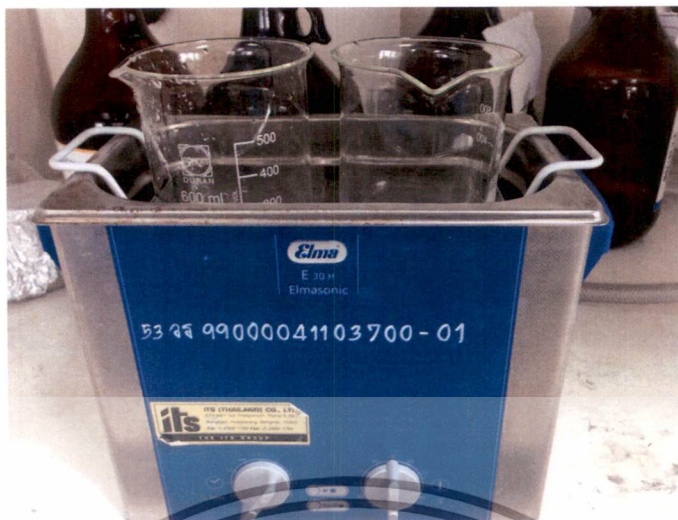
รูปที่ 3.7 ภาพแสดงเครื่องอัลตราโซนิกขณะที่กำลังทำความสะอาดแผ่นซิลิกอนด้วยอะซีโตน
