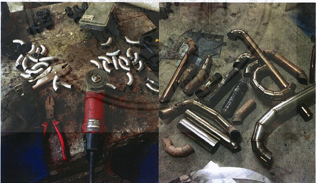
ภาพที่ 3.13 วัสดุอุปกรณ์ที่ใช้ในสร้างชิ้นงาน ได้แก่ ข้องอเหล็กหลายขนาด
