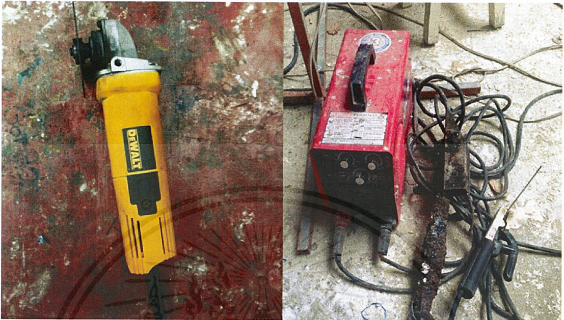
ภาพที่ 3.10 เครื่องเจียร เครื่องเชื่อม
