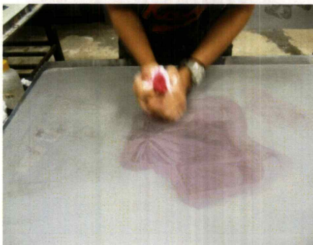
ภาพที่ 3.31-3.32 ขั้นตอนการล้างหน้าเพลท และเช็ดเรดแลคเกอร์
