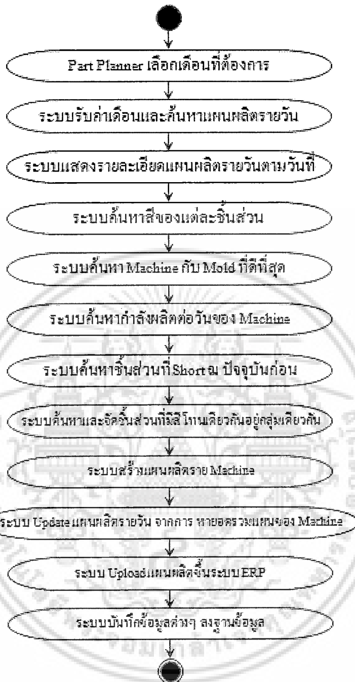
รูปที่ 4.4 แอกทิวิตีไดอะแกรม Generate Machine Plan
