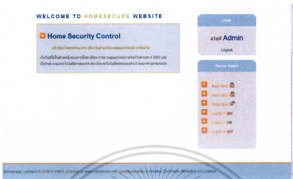
รูปที่ 5.2 เว็บไซต์ควบคุมอุปกรณ์ภายในของบ้าน (หลังเข้าสู่ระบบ)
