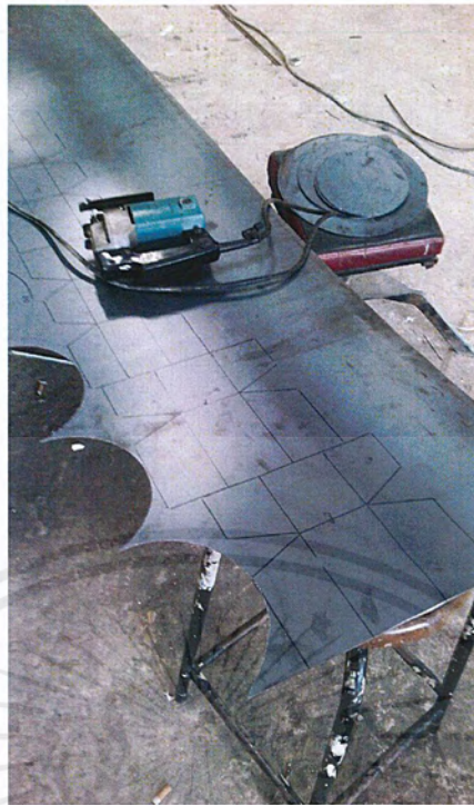
ภาพที่ 3.16 : ภาพการใช้เลื่อยไฟฟ้าตัดแผ่นเหล็กที่ร่างแบบไว้
