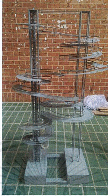
ภาพที่ 3.28 ทำการลงสีรองพื้นด้วยสีเทาเพื่อกันสนิม
