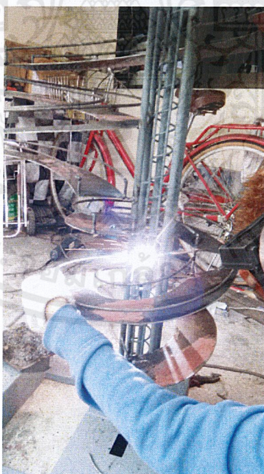
ภาพที่ 3.25 ตัดเหล็กเส้นและเชื่อมเป็นทางกันรางเพื่อไม่ให้ลูกเหล็กตกหล่นลงข้างๆขณะเลื่อนไหล อยู่ในตัวงาน
