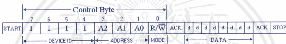
รูปที่ 2.41 รูปแบบการเขียน/อ่านข้อมูลแบบ I 2 C BUS
