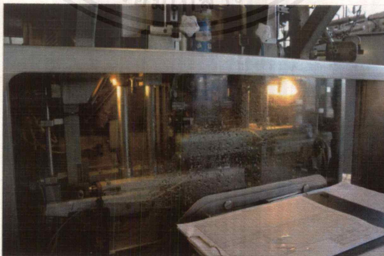
รูปที่ 3.1 หัวจ่าย A และหัวจ่าย B ของเครื่องจักรบรรจุผลิตภัณฑ์นมยูเอชทีประเภทกล่อง
