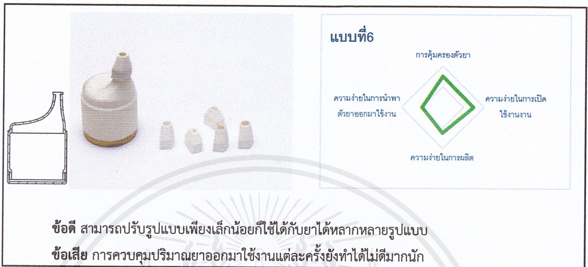
ภาพที่ 3- 9 แสดงแบบโมเดลที่ 6 พร้อมผลการทดสอบ
