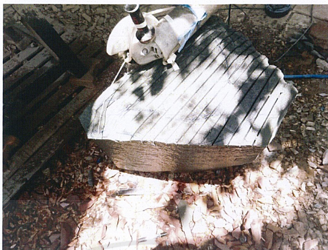
ภาพที่ 43 : วิธีการตัดด้วยการไม่ใช้น้ำหล่อเลี้ยง
