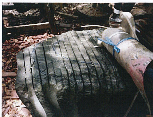
ภาพที่ 41 : วิธีการขึ้นรูปด้วยการตัดหินเป็นเส้น
