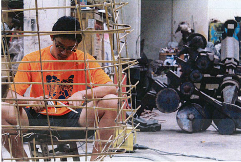
ภาพประกอบที่ 44 : ภาพขั้นตอนการมัดและตัดไม้ไผ่ด้วยความร้อน
