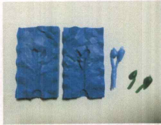
ภาพที่ 4.31 แม่พิมพ์ยางหัวหมดโลหะรูปทรงดอกพุด
