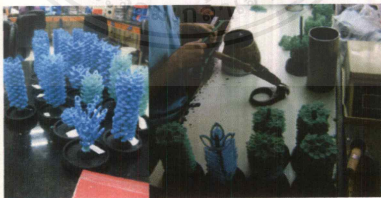
ภาพที่ 2.132 การติดต้นเทียนและชิ้นงานที่ฉีดเทียนแล้ว
