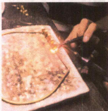
ภาพที่ 2.141 การประกอบชิ้นงานด้วยการเชื่อมประสาน
