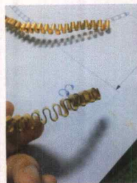
ภาพที่ 4.39 ตัดโครงสร้อยจากแผ่นทองเหลือง
