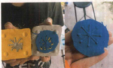
ภาพที่ 3.3 สร้างรูปทรงสามมิติจากการหล่อ แต่ไม่สามารถเก็บรายละเอียดได้
