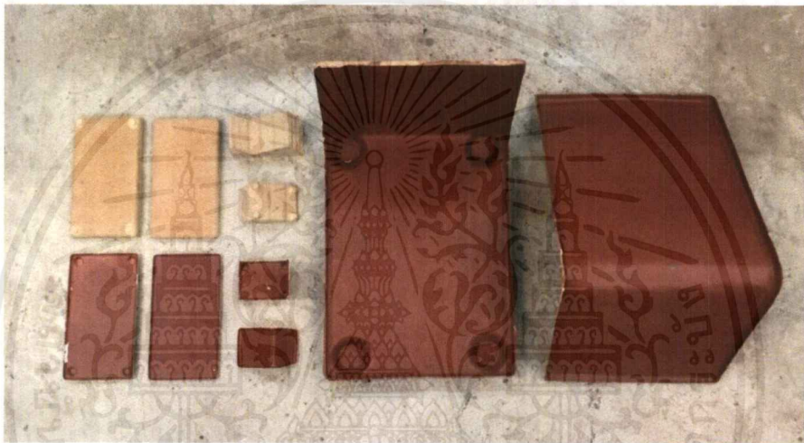
ภาพประกอบที่ 5.1 แม่พิมพ์ (Mold)
